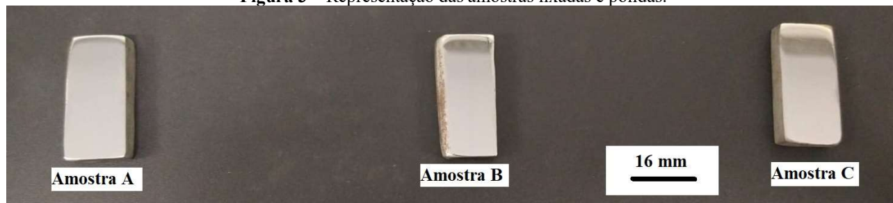
Figura 3 – Representação das amostras lixadas e polidas.
