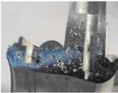
*Figura 16 - Peça de fundição injetada com porosidades (Eastern Alloys Inc. 2012).*
