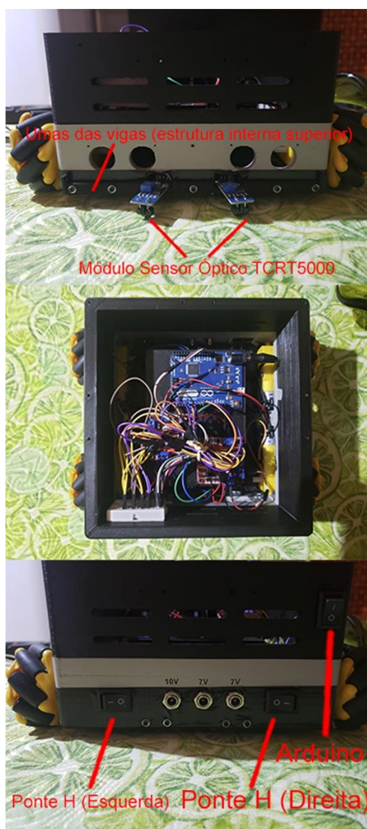
Figura 6: Montagem Final CAG
