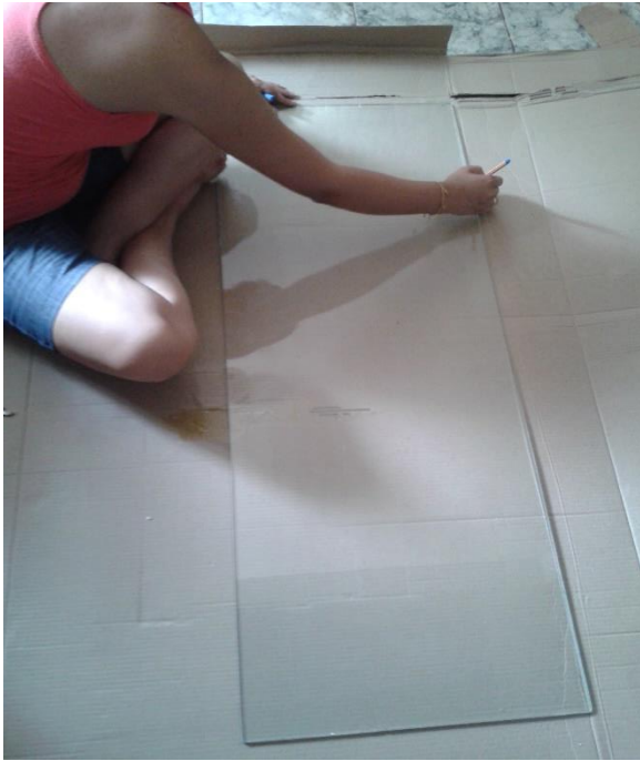
Contornando o tampo da mesa de acordo com a medida do tampo de vidro
