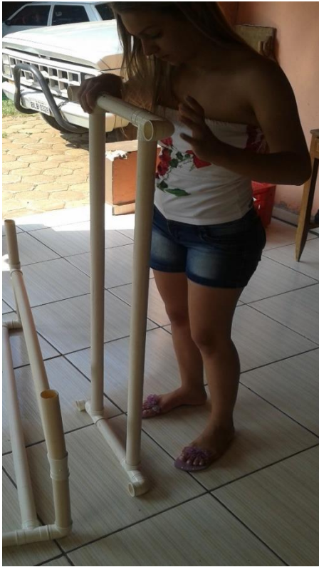
Montagem da parte superior da mesa.
