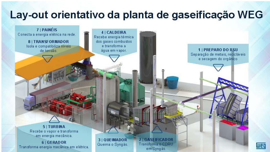
Figura 13 - Planta Gaseificação WEG
