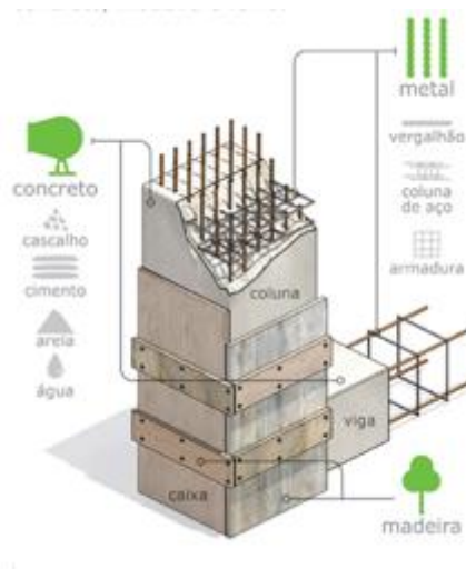
Figura 2: A construção convencional utiliza em suas estruturas materiais como concreto, madeira e aço.
