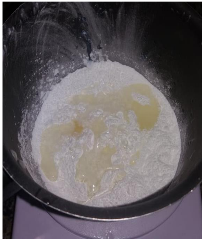
Figura 15 – Foto com o isetionato de sódio, plantarem e o óleo de coco na panela em banho maria
