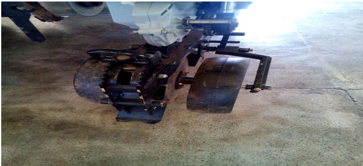
Figura 5. Retirada das unidades de cobertura de plantio
