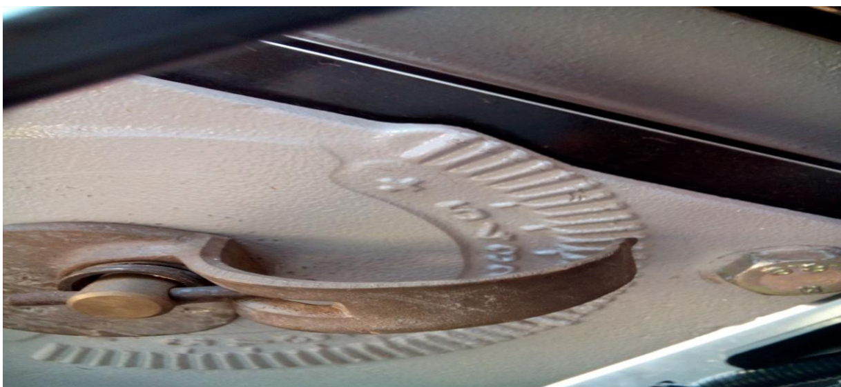
Figura 6 - Regulagem da pressão do vácuo no dosador.
