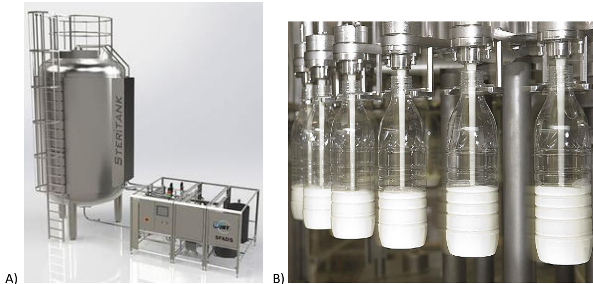
Figura 10: a) tanques assépticos e b) embalagens assépticas e estéreis.
