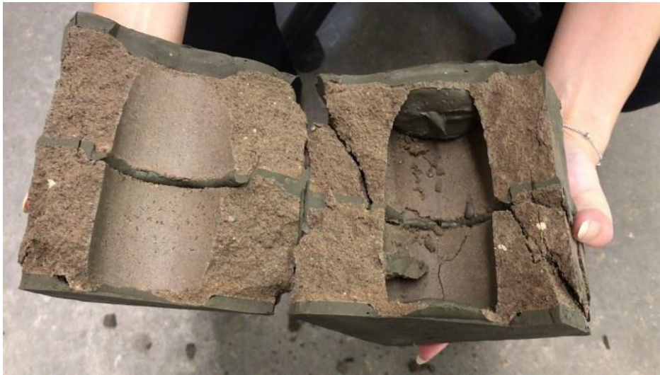
Figura 10 - Rompimento do tijolo ecológico com argila expandida
