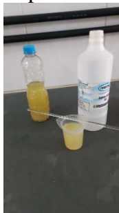
Figura 16: filtrado e etanol no fundo, no béquer mistura do filtrado e etanol que não precipitou.
