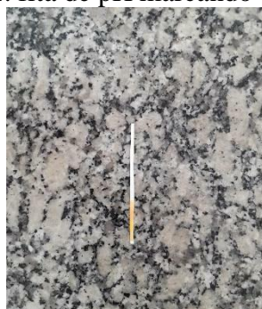
Figura 12: fita de pH marcando o pH de 3.
