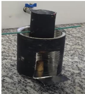
Figura 2: Calorímetro de Baixo Custo (modelo)
