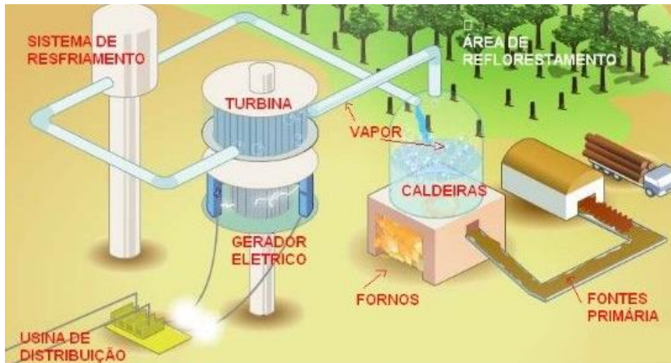
Figura 3: Representação Esquemática do Funcionamento da Usina Térmica a Biomassa
