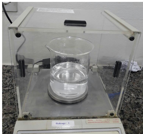
Figura 5: Pesagem da Água Destilada.
