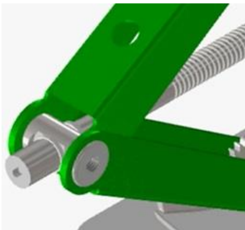
Figura 28: Eixo de apoio do fuso.
