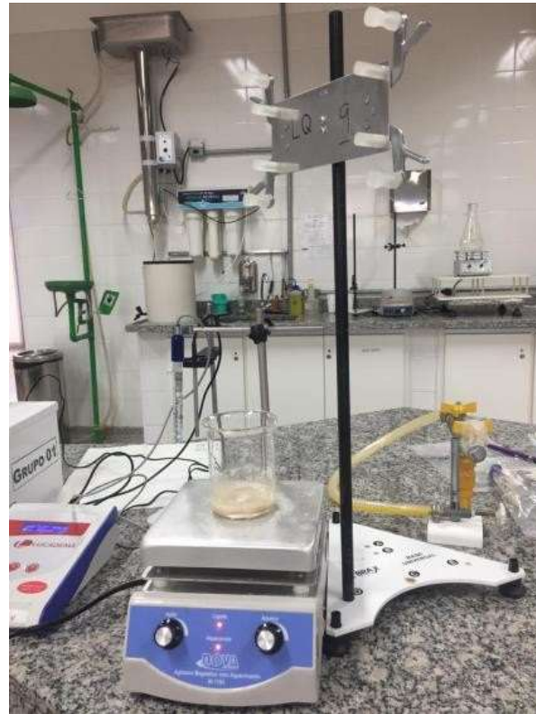
Figura 24 - Aparelhagem da técnica de titulação potenciometrica utilizada para determinar o grau de desacetilação (GD) da quitosana
