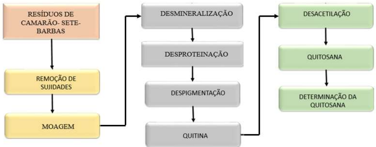
Figura 12 - Esquema dos processos que foram realizados para a obtenção da quitosana neste trabalho
