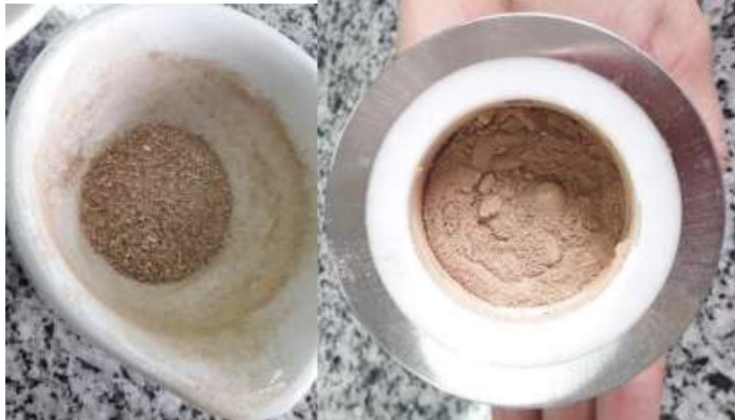
Figura 16 – Amostras moídas: a da esquerda previamente moída a mão; a da direita moída no moinho planetário.
