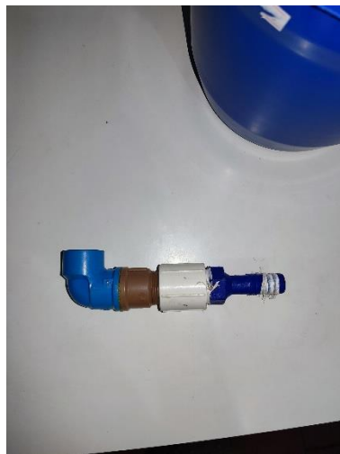
Imagem 5: por fim, um adaptador espigão foi conectado. Fonte: acervo pessoal do projeto, 2021.
