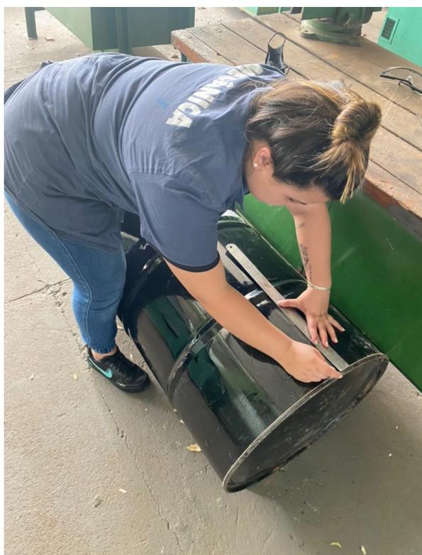
**Figura 2** - Traçando a linha no local do corte
