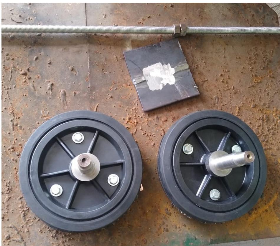
Figura 5 – Sistema de instalação dos rodízios.
