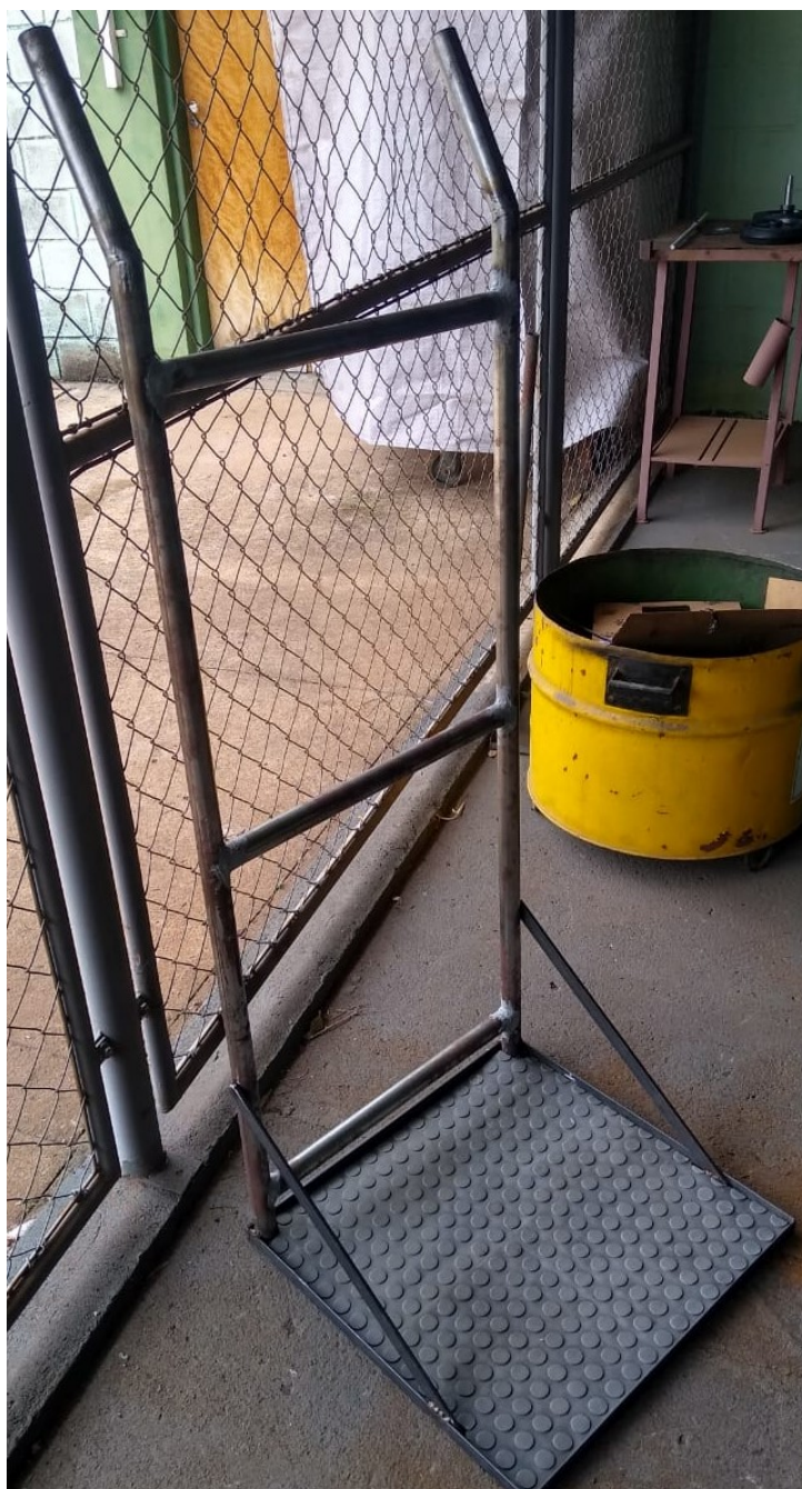
Figura 7 – Estrutura do carrinho e base.
