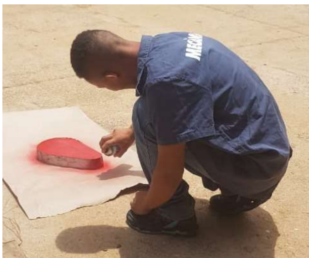
FIGURA 5 – Pintura da proteção da polia
