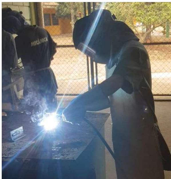
Figura 3 – Soldagem com eletrodo da estrutura
