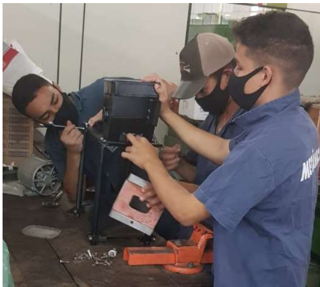
FIGURA 6 – Montagem do ralador na estrutura base
