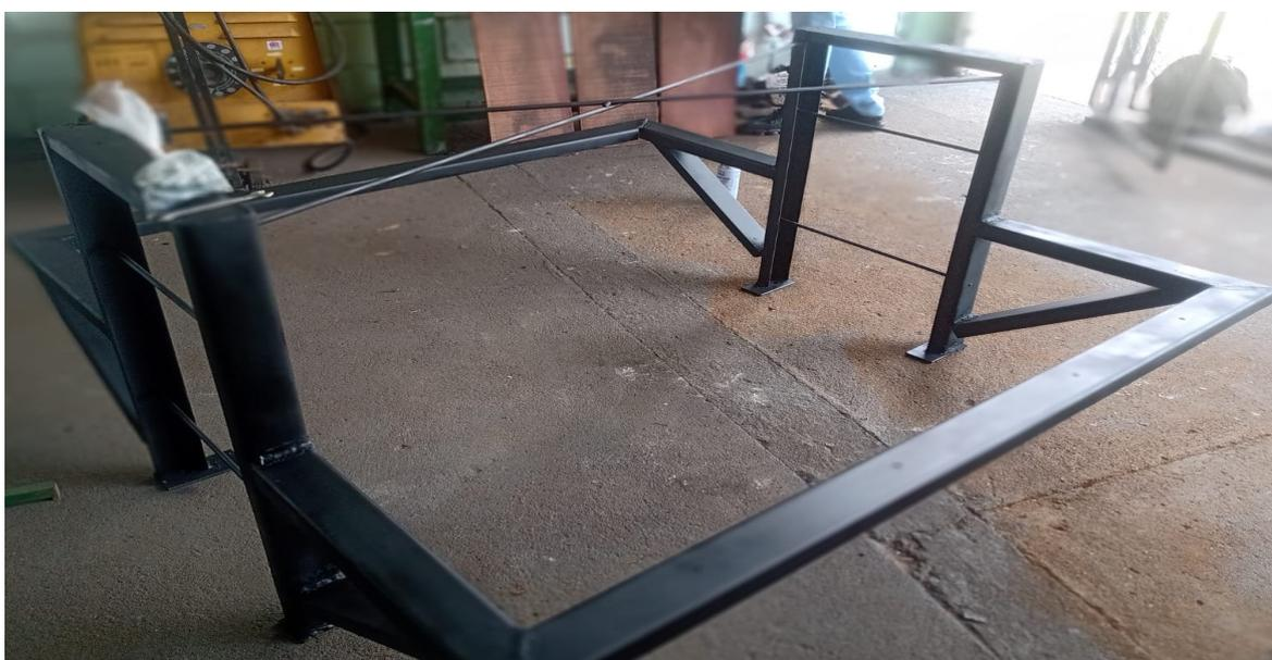
**Figura 3** - Instalação das travas e sapatas.
