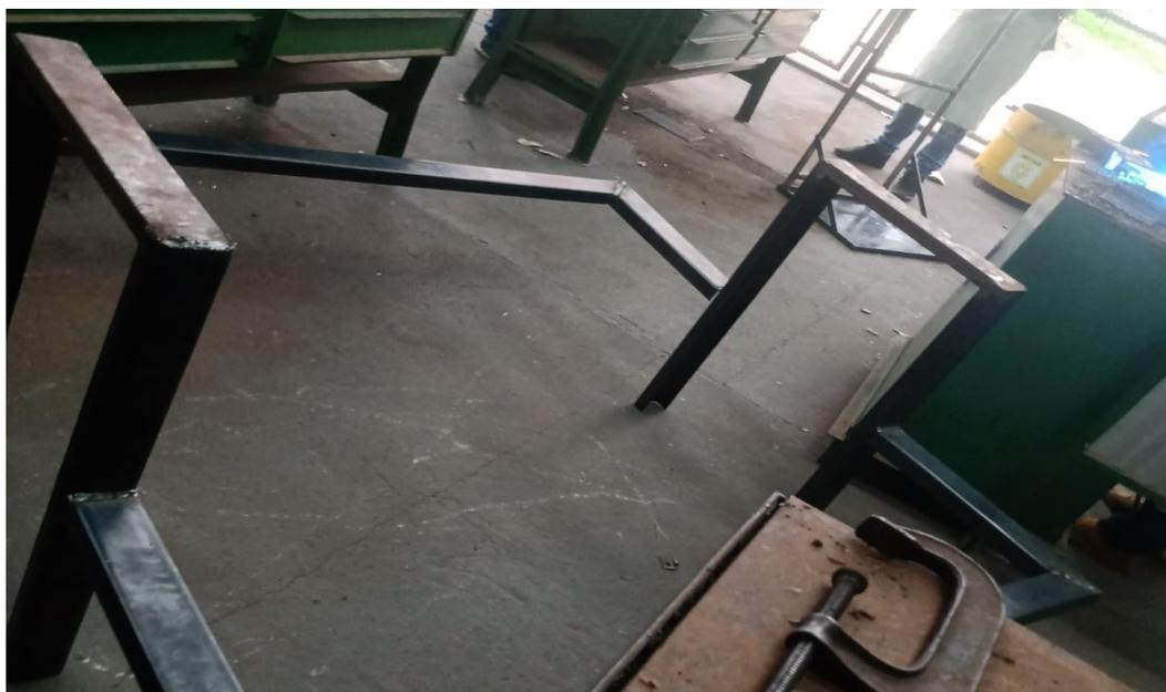
**Figura 2** - Soldagem da trave e dos bancos.
