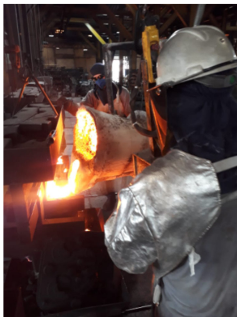
Figura 43 – Fundido o molde da fêmea do cardam
