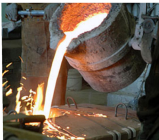
Figura 7 – Metal sendo vazado em um molde
