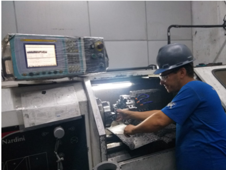
Figura 37 – Torneamento e furação dos pinos e guias e bucha do estampo
