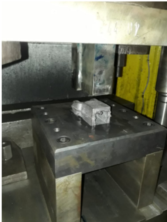
Figura 50 – Fêmea do cardam no estampo de rebarbação
