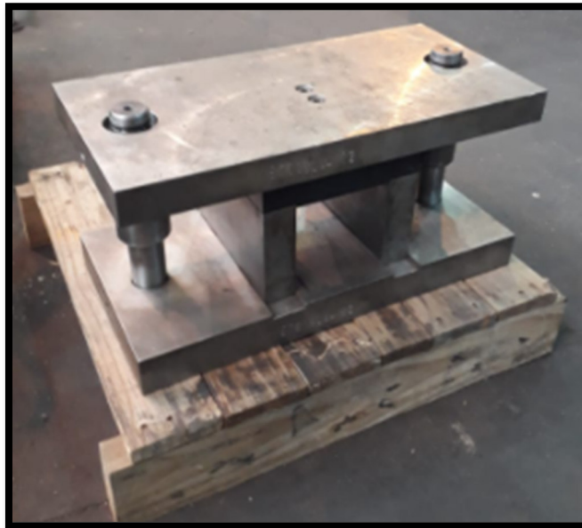
Figura 41 – Montagem completa do estampo de rebarbação ET-019244-02
