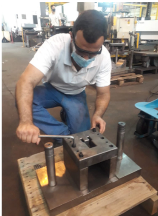
Figura 39 – Montagem da base do estampo ET-019244-02-05
