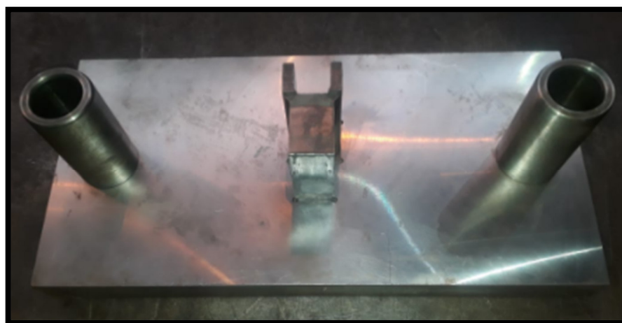
Figura 40 – Montagem da tampa do do estampo ET-019244-02-10
