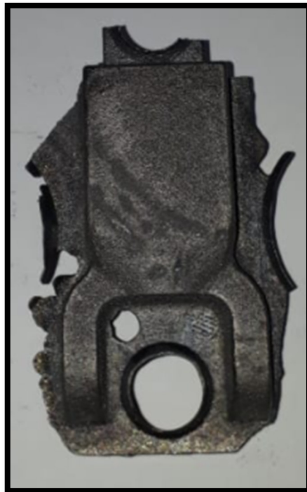
Figura 45 – Peça fundida da fêmea do cardam com rebarbas
