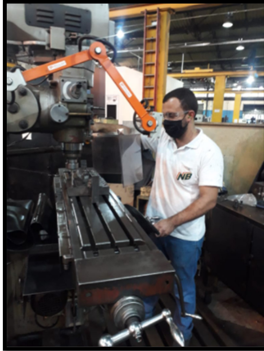
Figura 34 – Fresagem ET-019244-02-04 - base do estampo
