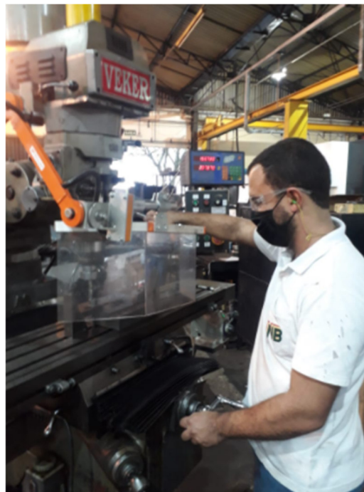
Figura 35 – Fresagem ET-019244-02-07 – tampa do estampo
