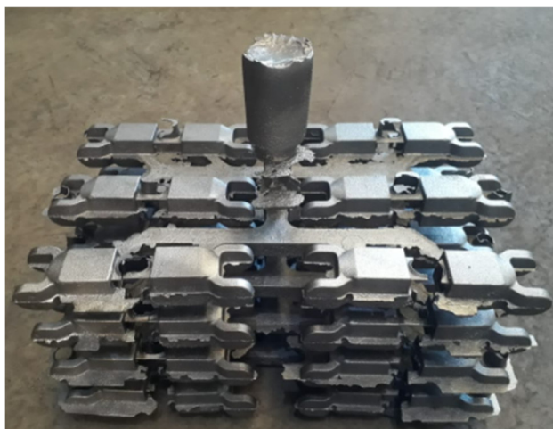
Figura 44 – Árvore com canais e peças da fêmea do cardam com rebarbas
