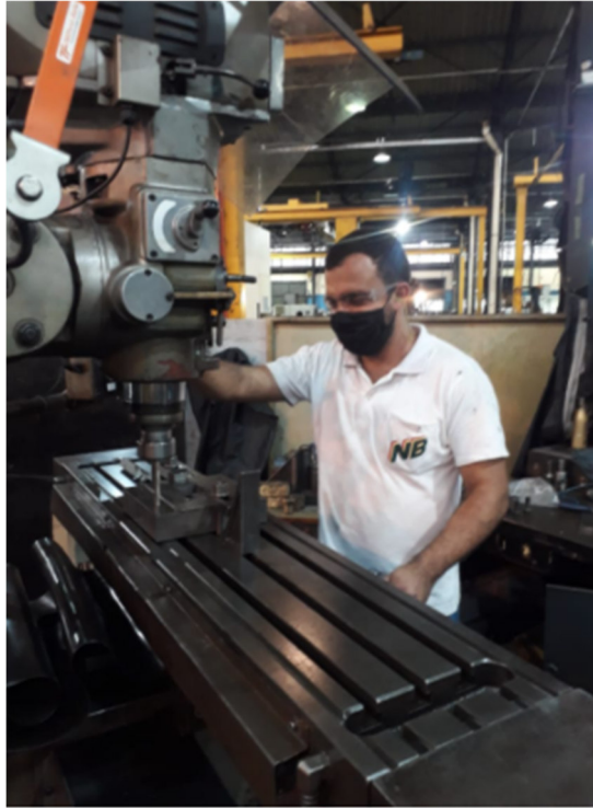
Figura 36 – Fresagem ET-019244-02-03 – colunas do estampo
