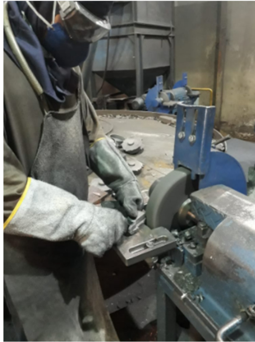
Figura 46 – Rebarbação com rebolo em um esmeril
