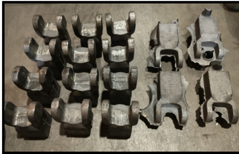
Figura 52 – Peças da fêmea do cardam rebarbadas por estampagem
