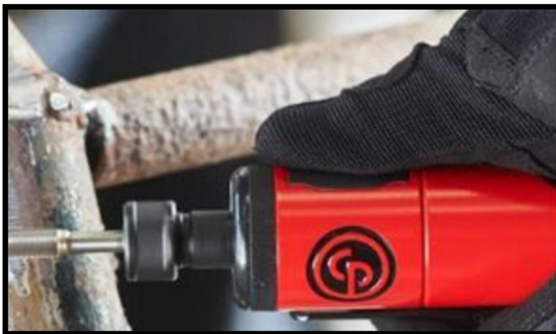
Figura 14 – Rebarbação convencional por retifica.
