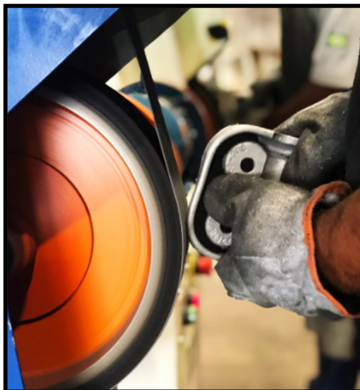
Figura 14 – Rebarbação convencional por lixadeira.
