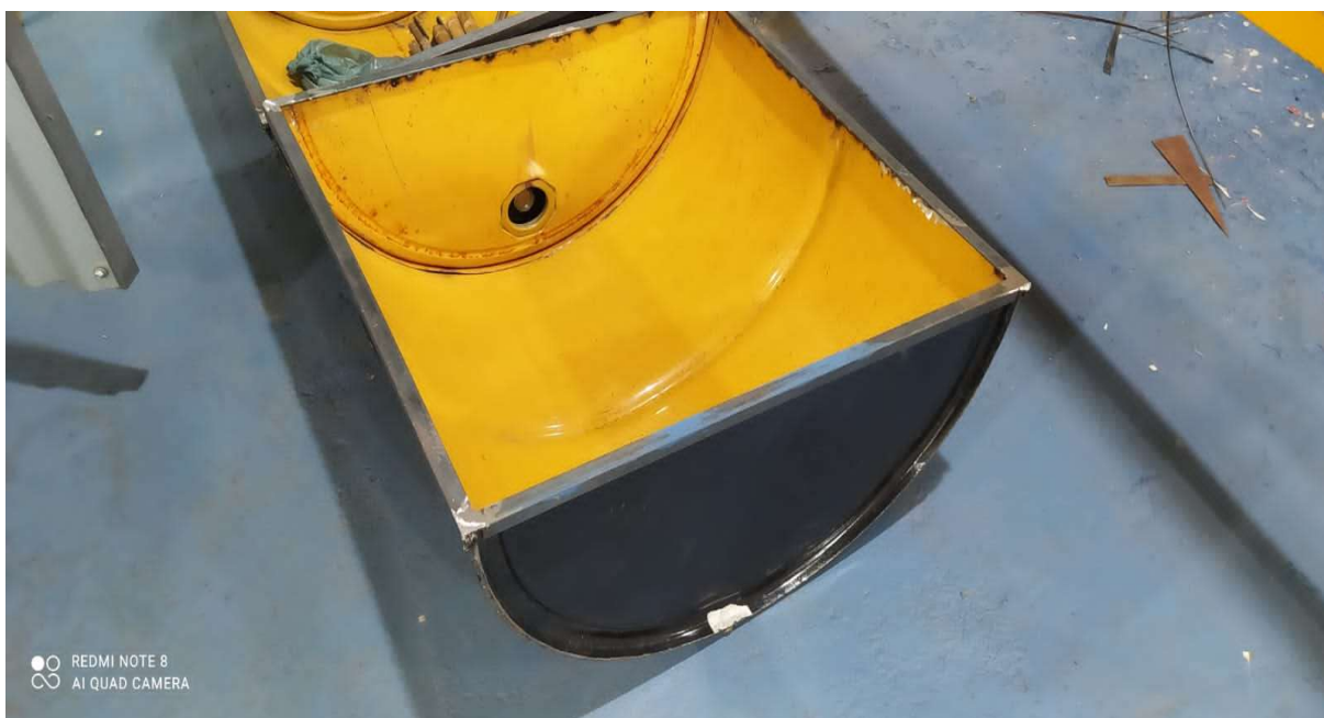
Figura 7 – Instalação das cantoneiras na parte superior.
