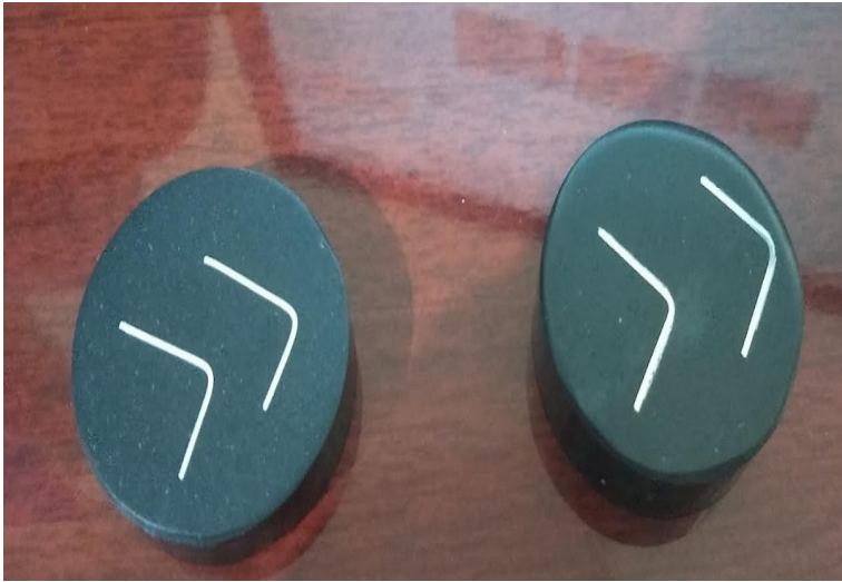
Figura 12 – Amostras polidas e atacada com reagente Nital 2%.
