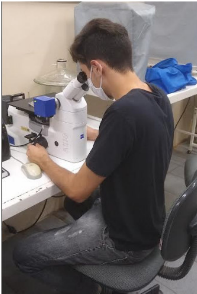
Figura 13 - Análise no microscópio com o objetivo de visualizar as inclusões antes do ataque químico com o Nital 2% e após o ataque químico verificar as microestruturas e seus respectivos grãos de Perlita. Podendo assim verificar de ambas as amostras se houve alguma mudança da longitudinal para a transversal
