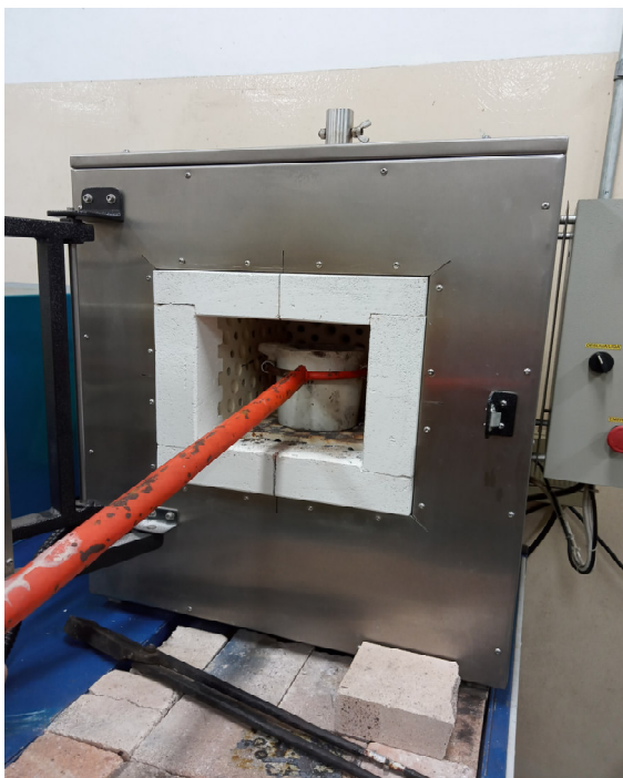
Figura 01: Forno de indução
