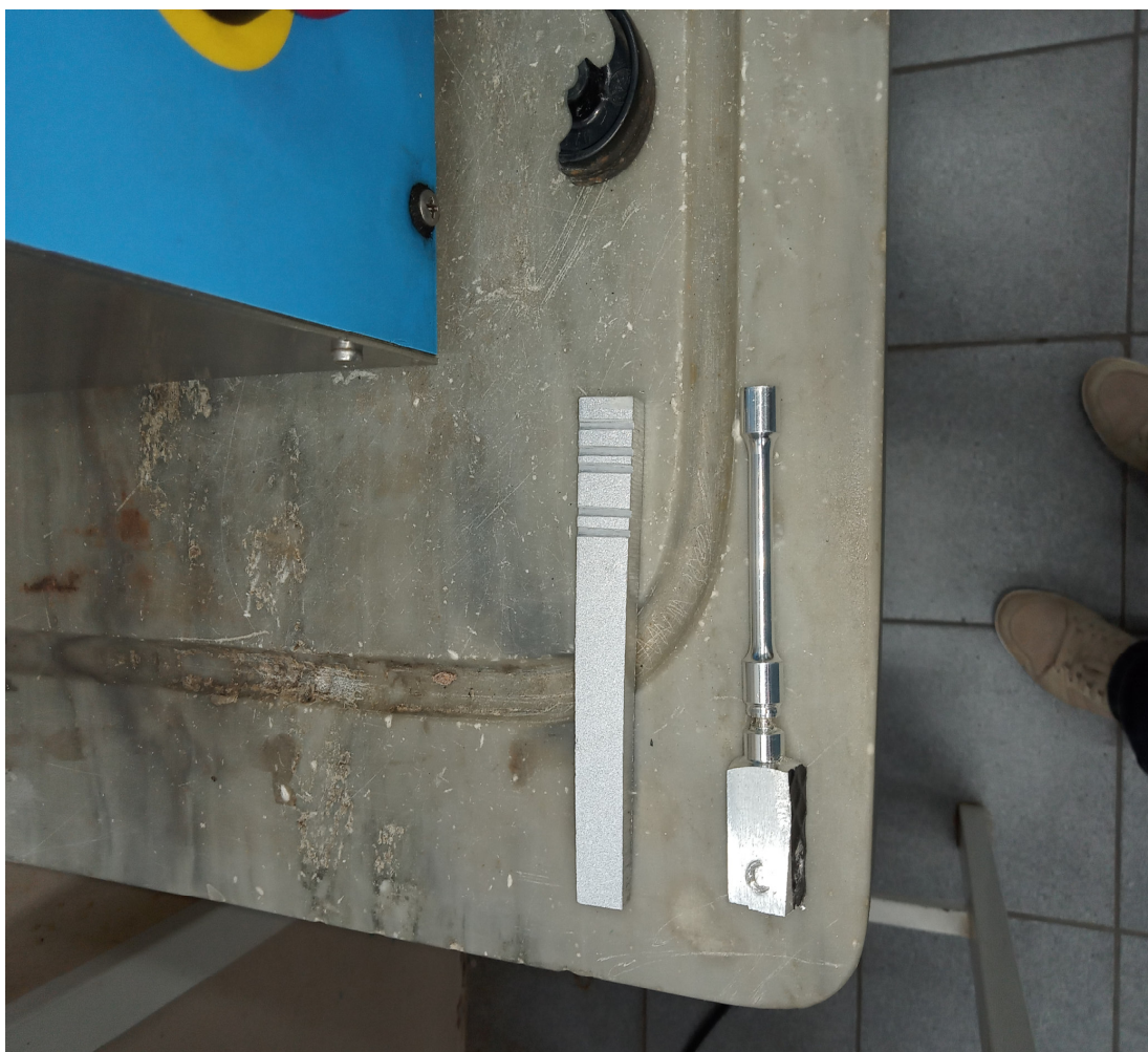
Figura 1: Corpo de prova: borda externa e corpo de prova usinado
