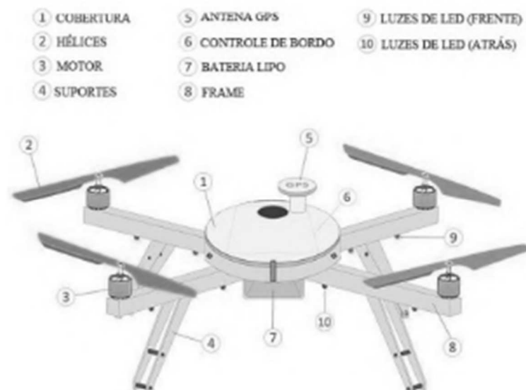
Figura 21 - Típicos componentes em um drone
