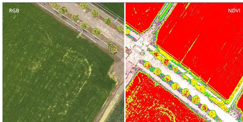
Figura 23 - Análise do Índice de Vegetação por Diferença Normalizada (NDVI) e uma transmissão em tempo real via RGB
