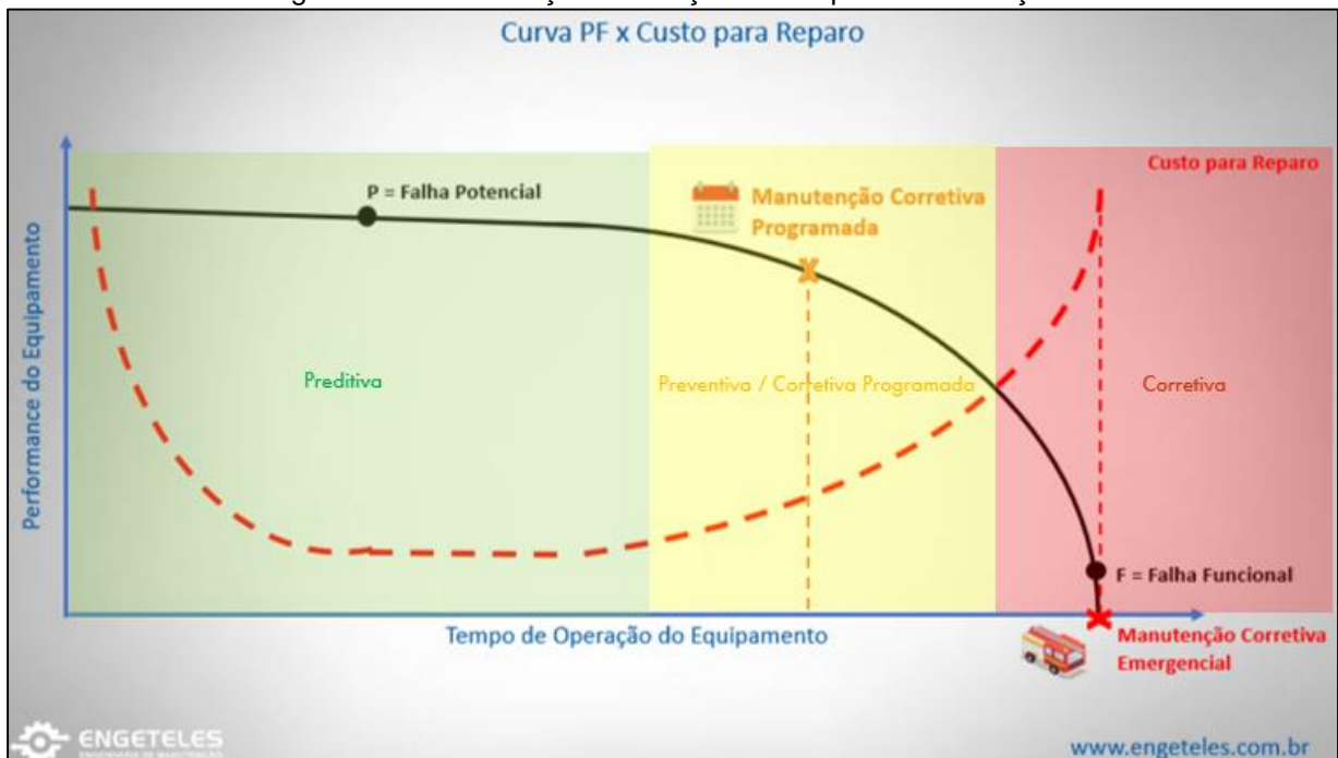
Figura 1.2 – Manutenção em função do tempo de intervenção
