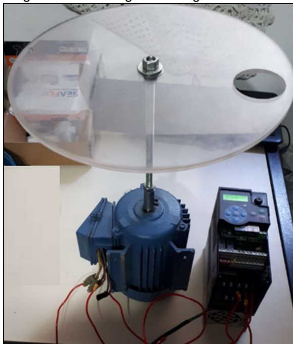
Figura 3.4 – Montagem do magazine no motor
