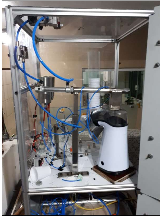
Figura 3.15 – Interligações elétricas e pneumáticas
