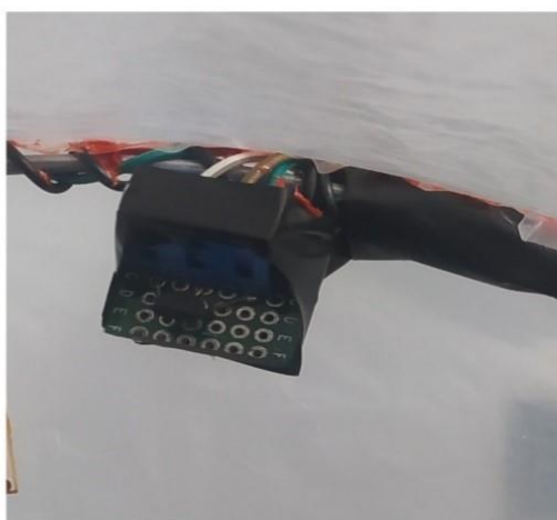
Figura 17: Sensor LDR, identifica a luz do local, quando escurece ao anoitecer, o sensor lê a claridade e manda sinal para o Arduino que liga a luz de led para acelerar a fotossíntese da planta.
