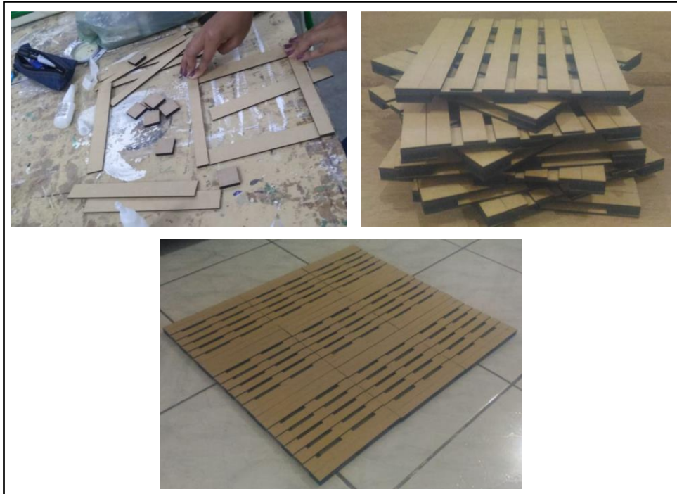
Figura 18- Montagem dos pallets para criação do piso
