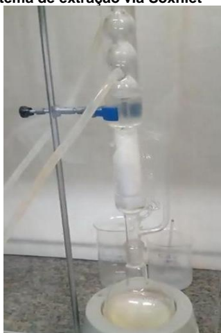
Figura 6 – sistema de extração via Soxhlet
