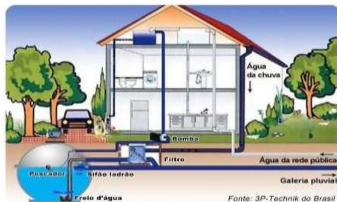
Figura 02 – Exemplo de captação de águas pluviais
