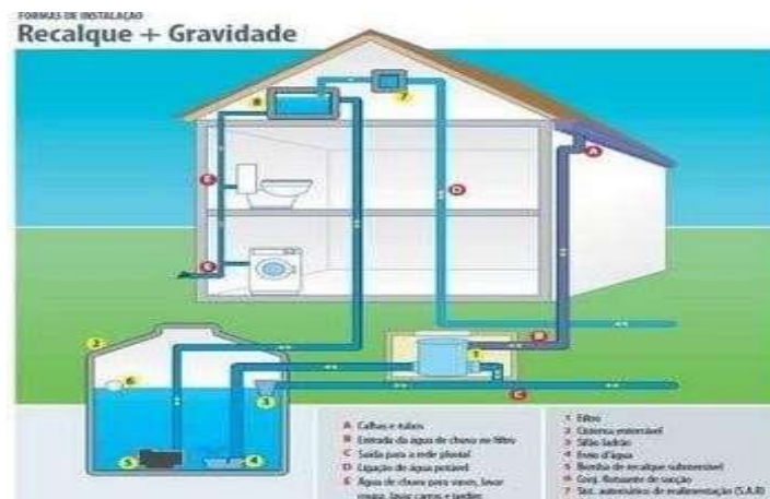
Figura 05 - Exemplo de sistema de recalque ou adução
