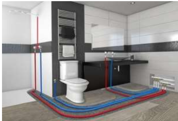
Figura 04 – Exemplo de sistema hidráulico pex
