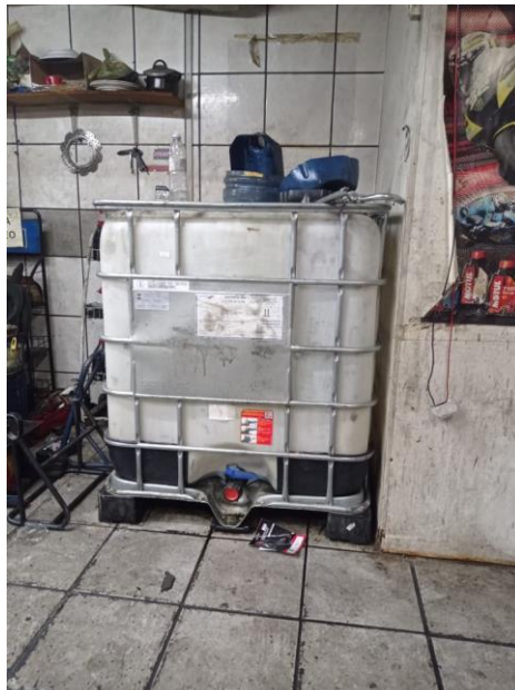
Imagem16 - Reservatório de óleo sujo
