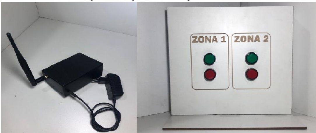
Figura 16 – Dispositivo central e painel de alerta
