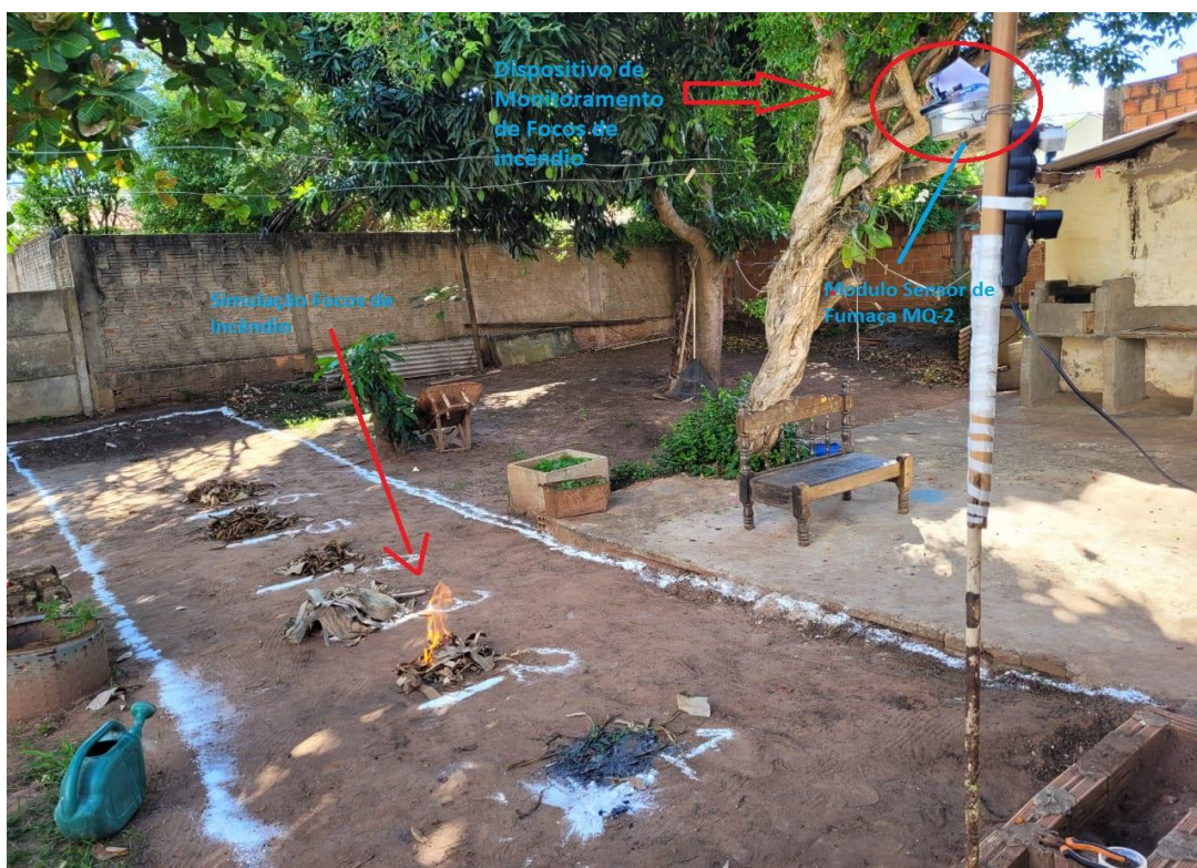
Figura 24 – Teste de raio de detecção do dispositivo de monitoramento com modulo sensor MQ-2
