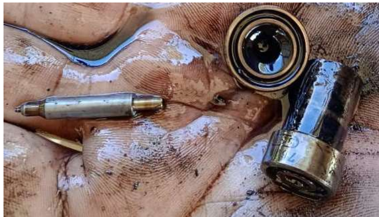
Figura 6 – Unidade Injetora Desmontada.
