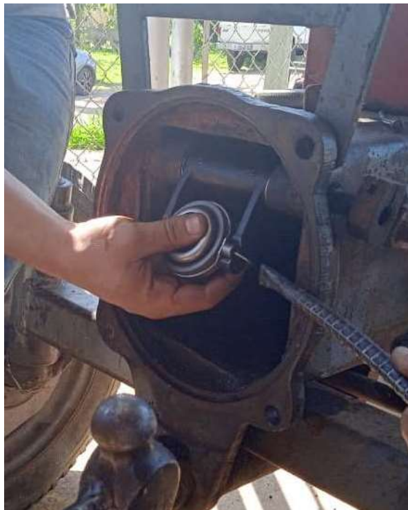
Figura 10 – Substituição do Rolamento.
