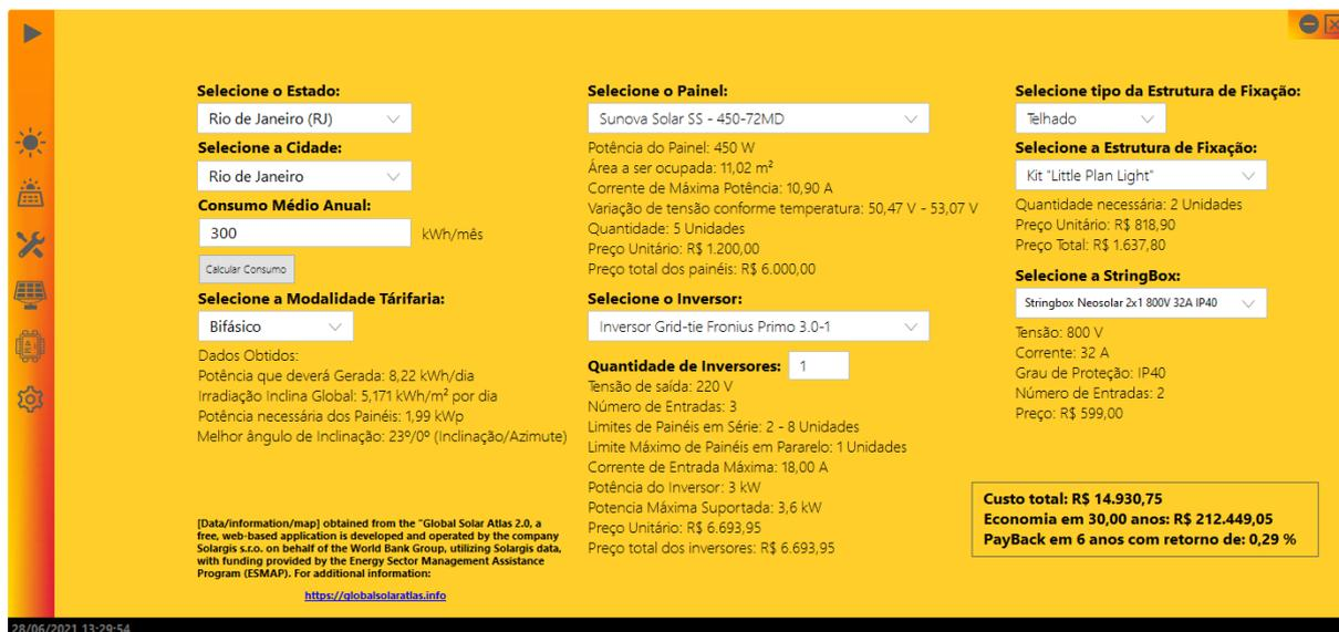
Para uma unidade consumidora e 300 kWh/mês com modalidade bifásica o aplicativo calculou que a geração do sistema deve ser de 1,99 kWp para suprir a demanda energética da unidade.
