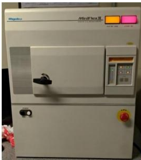
Figura 15: Difratômetro de raios X utilizado para a caracterização das amostras de QDs de ZnO. [Própria autora]
