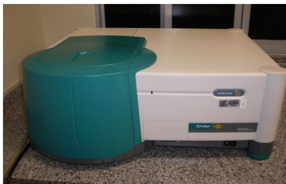
Figura 17: Espectrofluorímetro utilizado nas medições de emissão fluorescente das amostras. [25]
