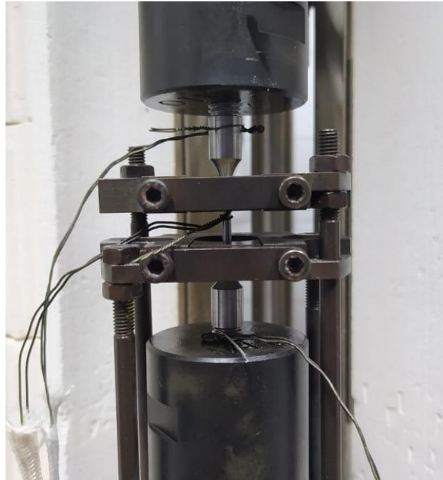
Figura 7 – Corpo de prova acoplado à máquina com o extensômetro, e os termopares devidamente fixados
