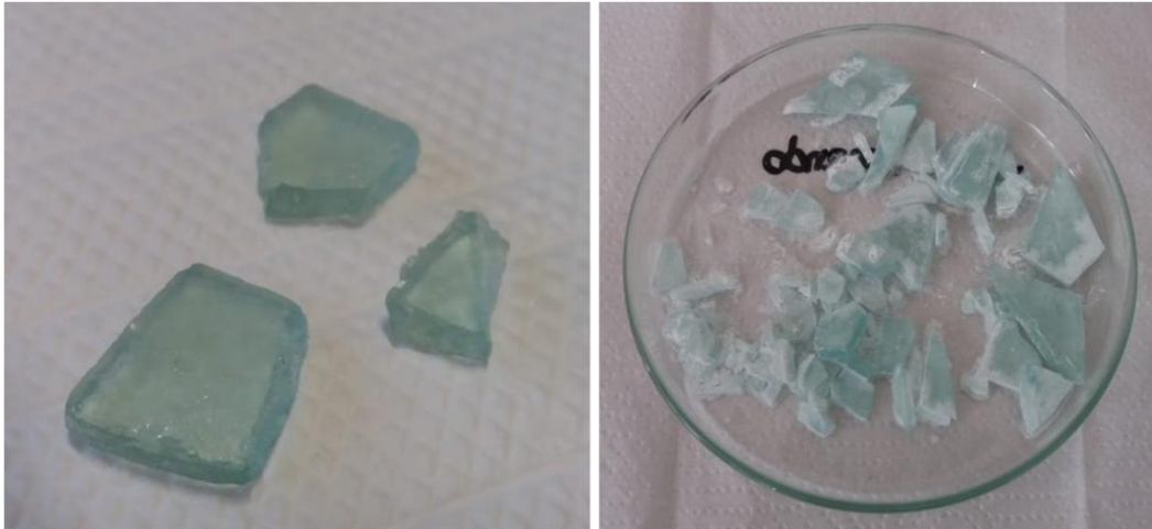
Figura 35 - Cacos de vidro após delaminação com solução de NaOH, sem lavagem posterior.
