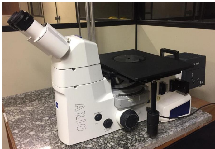
Figura 11 - Microscópio óptico utilizado para análise dos vidros.
