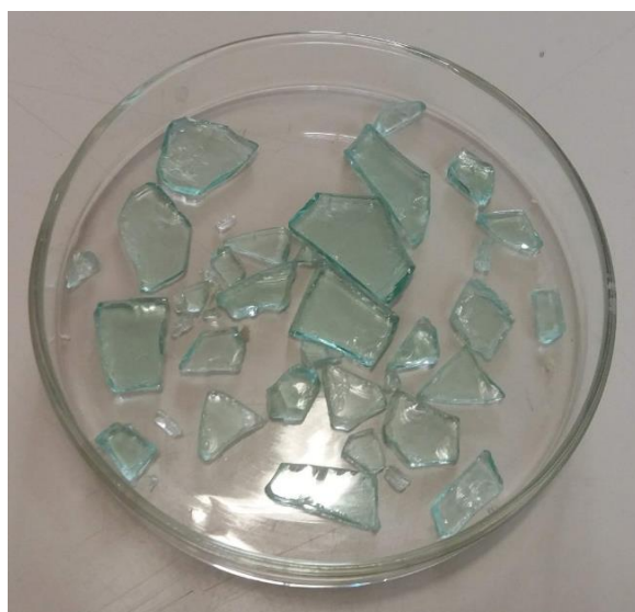
Figura 18 - Cacos de vidro após beneficiamento com acetato de etila.
