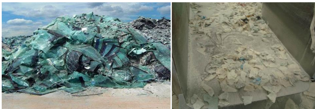
Figura 6 - Vidros de para brisas recebidos pela indústria de reciclagem (à esquerda) e esteira do moinho onde ocorre a separação do vidro e PVB (à direita) [2].
