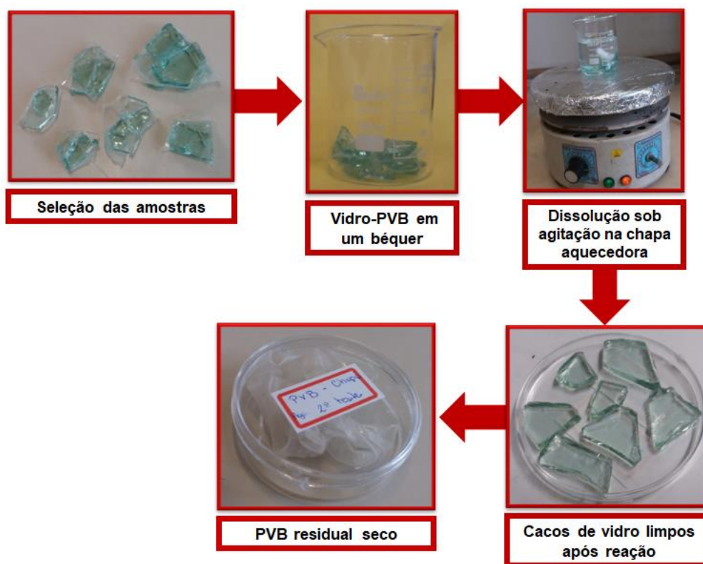
Figura 9 – Fluxograma do procedimento experimental para beneficiamento químico em diferentes solventes do vidro laminado.
