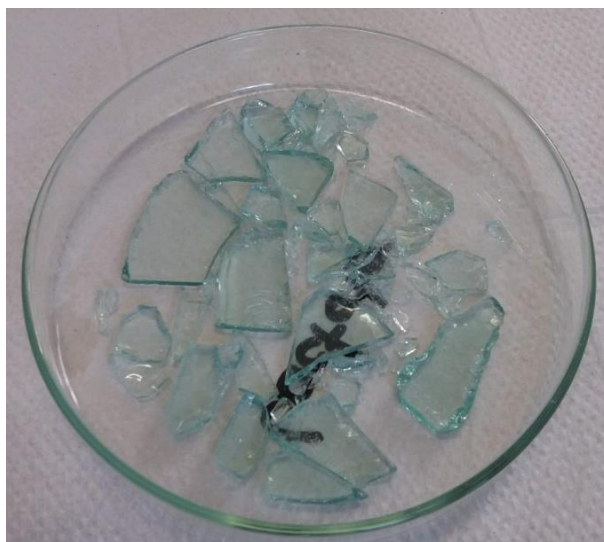
Figura 17 - Cacos de vidro após beneficiamento com lactato de etila.
