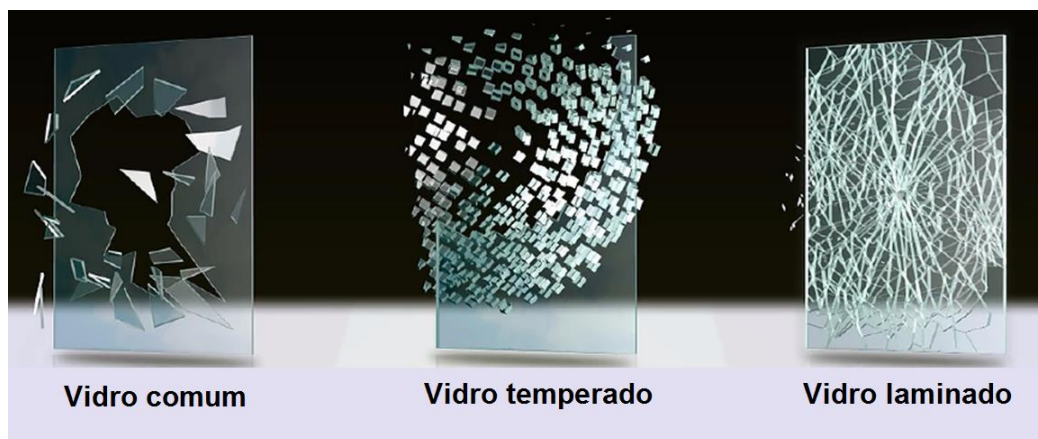
Figura 3 – Fratura em vidro comum, temperado e laminado [13].
