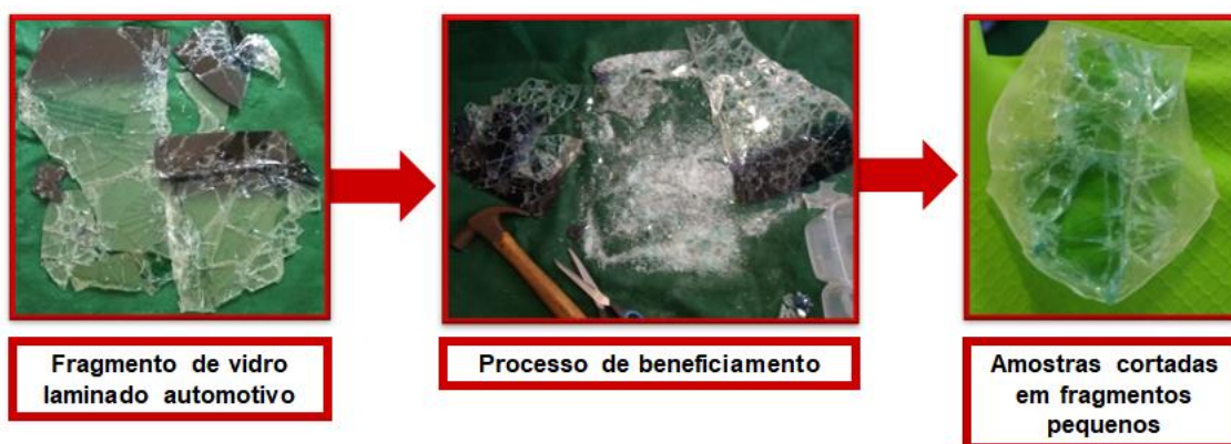
Figura 7- Preparação das amostras via beneficiamento físico.
