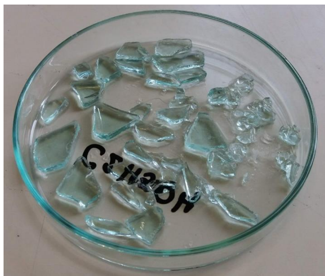
Figura 16 – Cacos de vidro após beneficiamento com álcool etílico.
