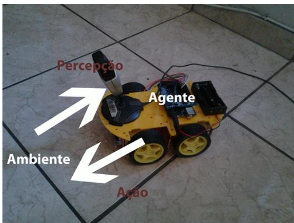
Figura 3: Ciclo de percepção e ação do robô móvel. Fonte: Elaborada pelo autor.
