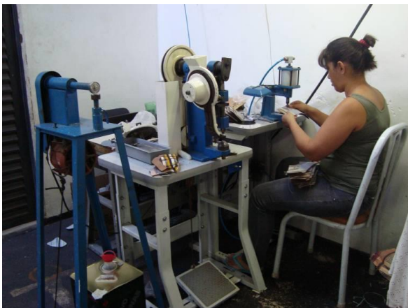
Figura 7: Máquina de Aplicar Ilhoses Elétrica e Pneumática Respectivamente. Fonte: Autor.
