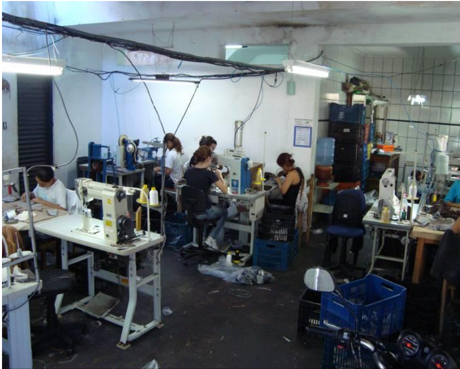
Figura 9: Mostra um local em condições insalubres com iluminação inadequada. Fonte: Autor
