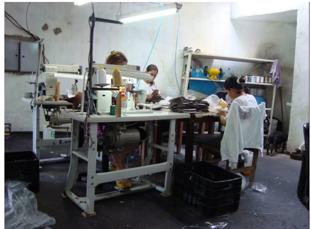
Figura 6: Mostra o Assento Inadequado da Coladeira de Peças. Fonte: Autor.
