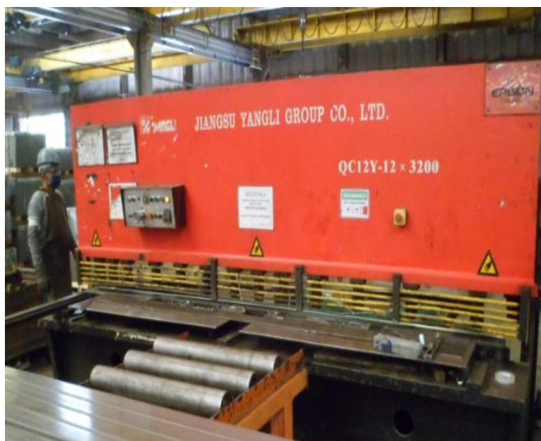
Figura 17 Guilhotina, maquinário para realização de cortes.
