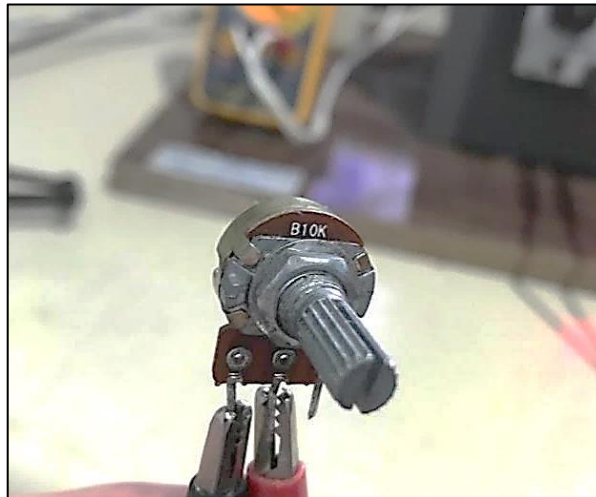
FIGURA 24 – POTENCIÔMETRO DE 10 k \Omega UTILIZADO
