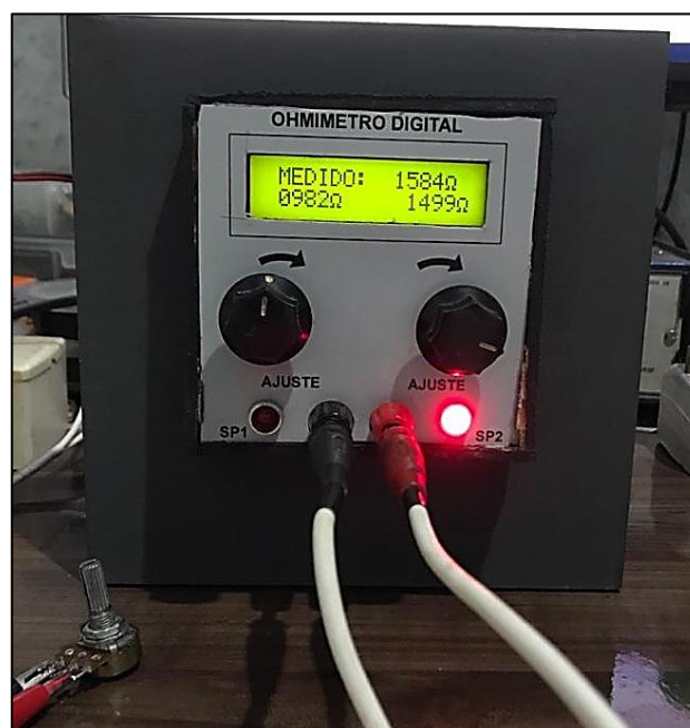
FIGURA 26 – RESPOSTA DO PROTÓTIPO AO MEDIR RESISTÊNCIA > SP2
