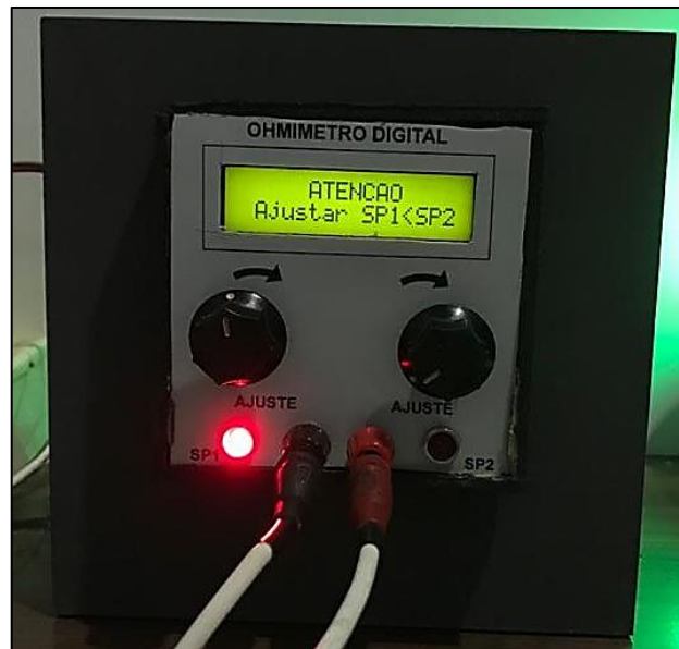
FIGURA 27 – SIMULAÇÃO DE RESPOTA DO PROTÓTIPO CASO SP1 > SP2
