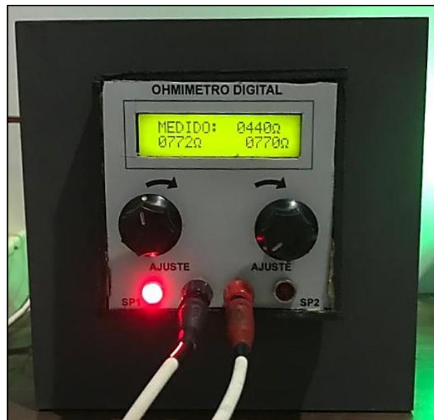
FIGURA 25 – RESPOSTA DO PROTÓTIPO AO MEDIR RESISTÊNCIA < SP1
