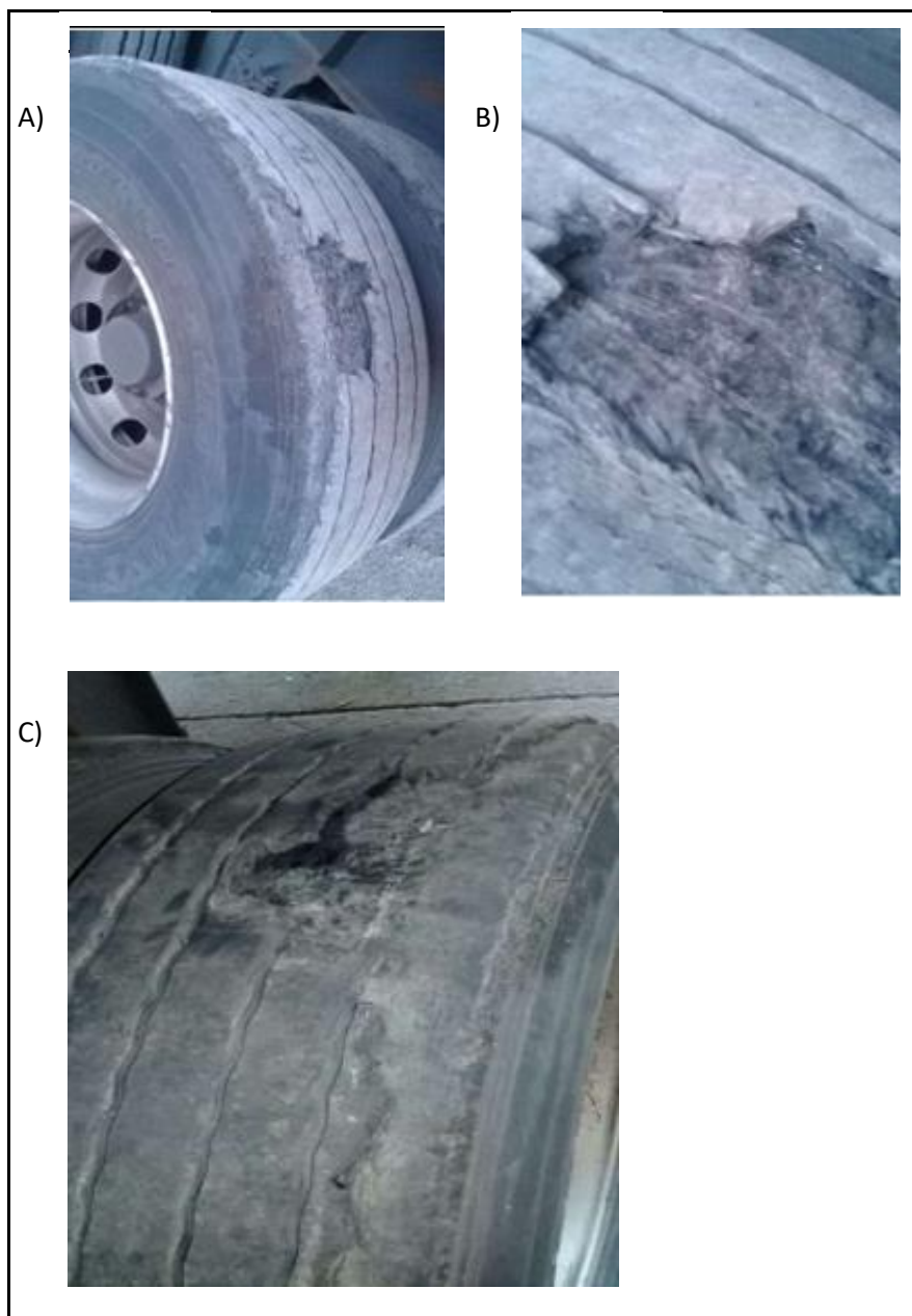
Figura 10: Dados do Laudo 1: A) Ombro do pneu; B) Banda de rodagem; C) Visão da largura da secção.
