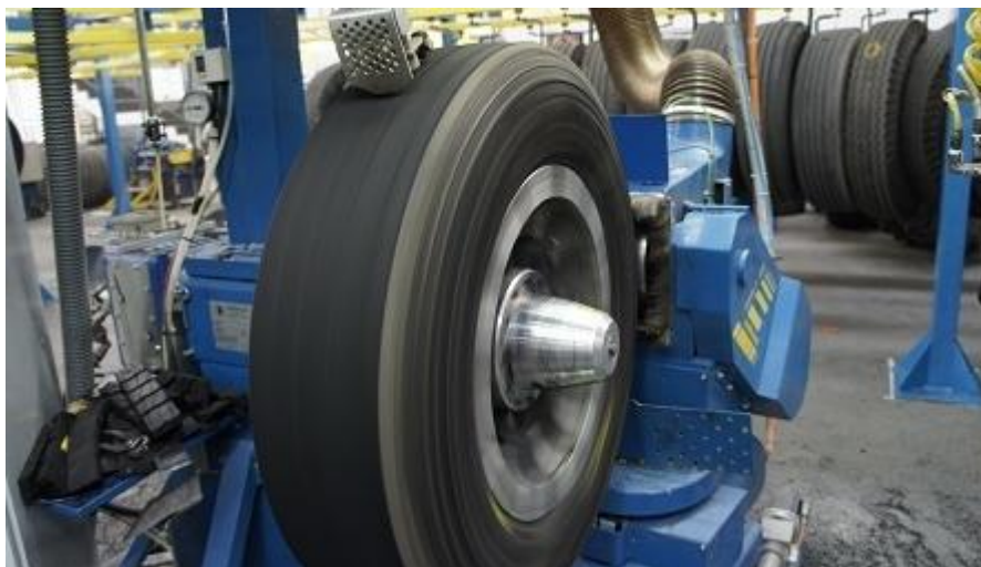
Figura 9. Raspagem da Banda de Rodagem
