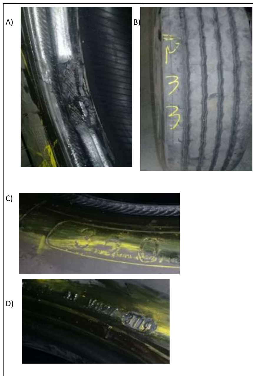
Figura 11: Dados do Laudo 2: A) Talão do pneu; B) Banda de rodagem; C) Marcação de fogo; D) DOT.
