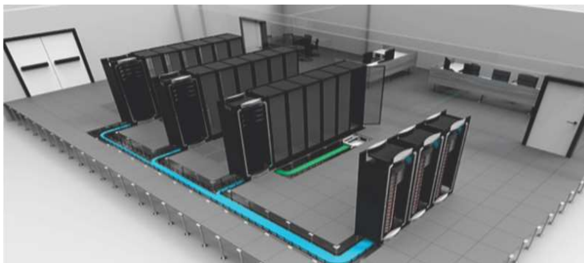
Figura 1 - Imagem de sala de Data Center com piso elevado
