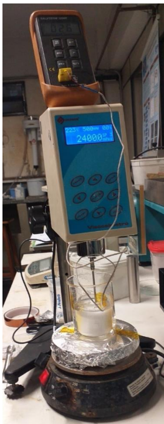
Figura 6: Equipamentos utilizados para determinação da viscosidade.
