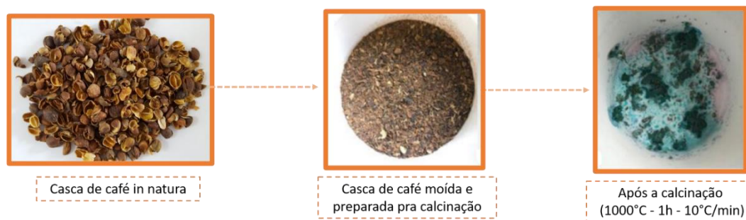
Figura 10: Fluxograma do beneficiamento da casca de café.
