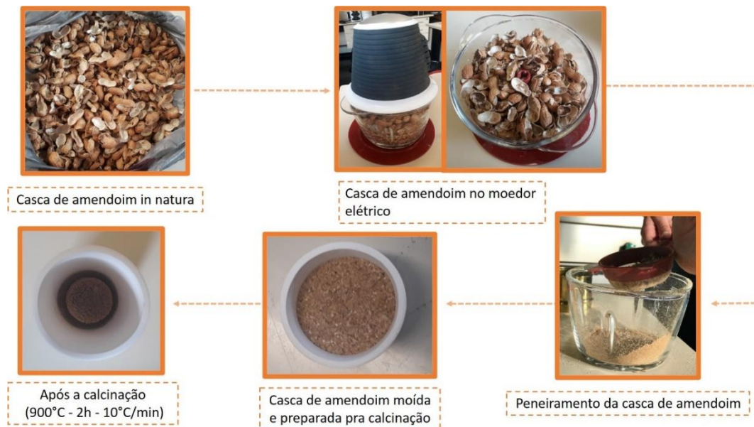
Figura 13: Fluxograma do beneficiamento da casca de amendoim.
