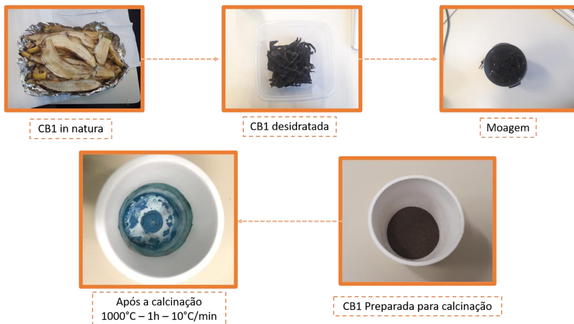
Figura 11: Fluxograma do beneficiamento da casca de banana (CB1).
