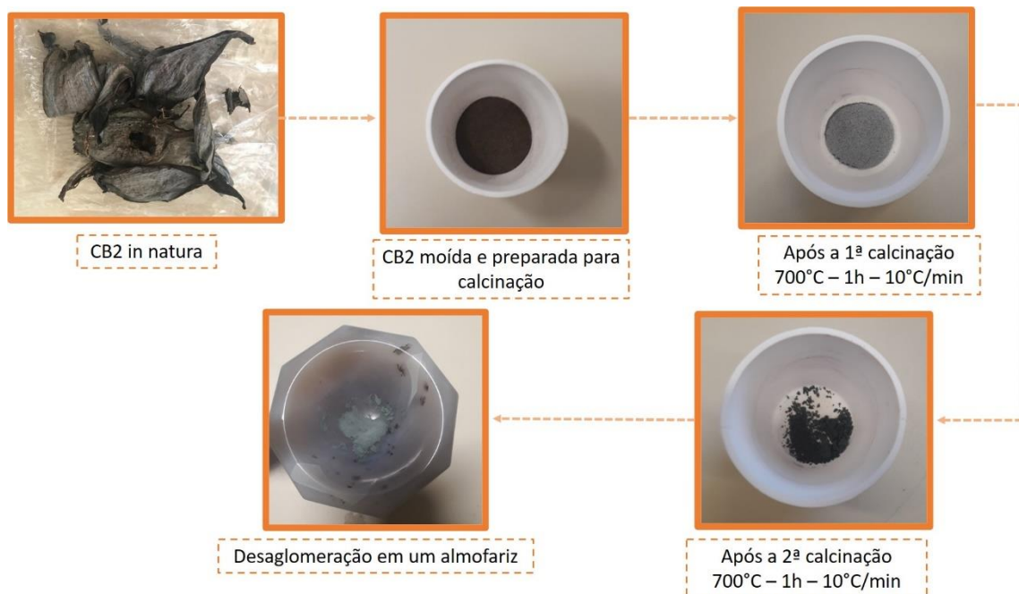
Figura 12: Fluxograma do beneficiamento da casca de banana (CB2).
