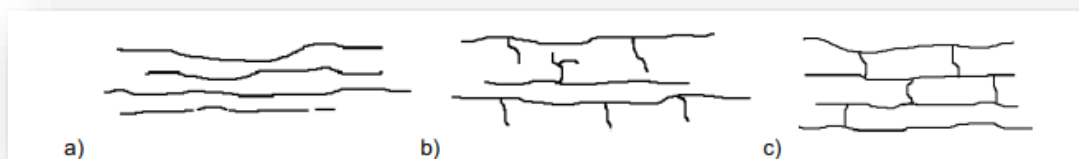
Figura - 14: Representação esquemática dos principais tipos de estruturas poliméricas observadas a) estrutura linear; b) estrutura ramificada e c) estrutura em rede.
