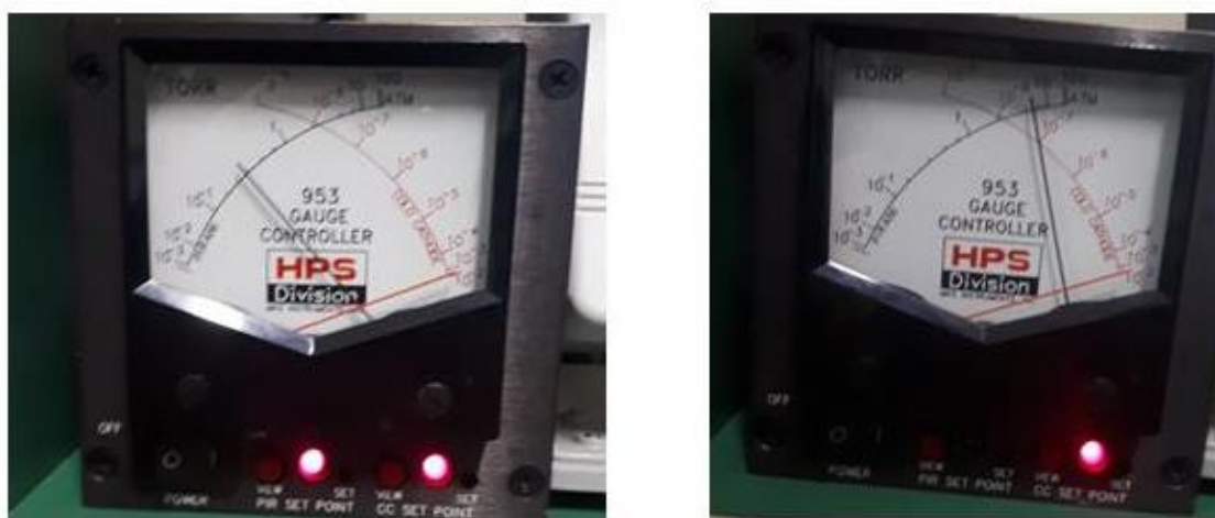
Figura 33 - Teste realizado após colocação do passador de tensão. (a) câmara em vácuo; (b) câmara em vácuo após 3 dias.
