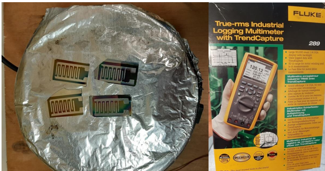
Figura 25 - Sensor em recozimento térmico e multímetro usado para medir a temperatura.
