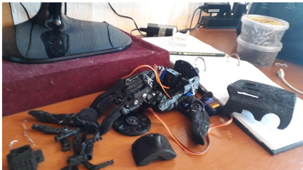
Figura 23 – Encaixe dos motores na mão.
