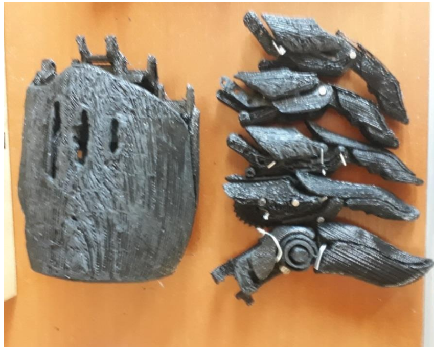
Figura 22- Partes da mão mecânica em plástico PLA.
