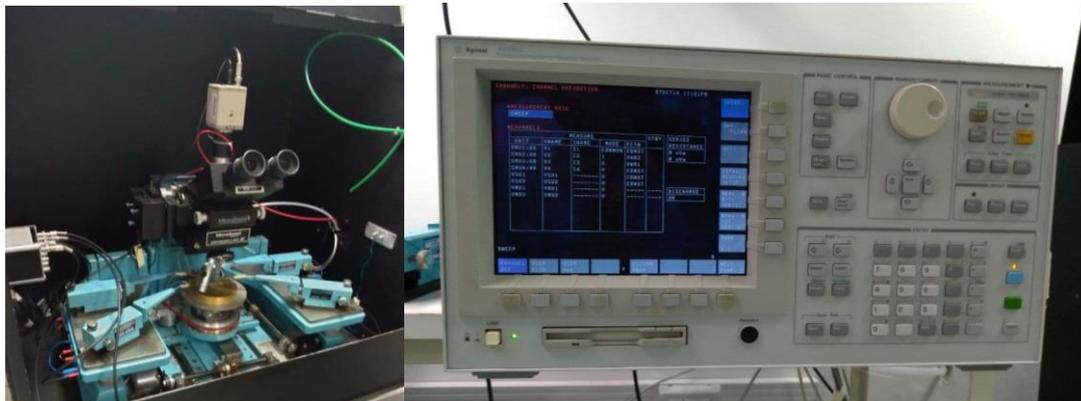
Figura 3.1.1 – Arranjo experimental: (a) Arranjo utilizado para posicionamento das micro pinças no pad de contato (a esquerda); (b) Equipamento de medição (a direita).
